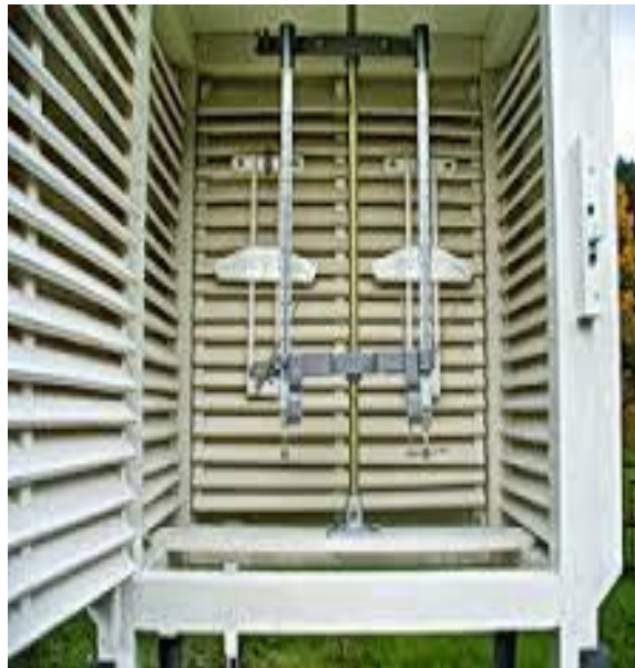
ნახ.1.2.2. თერმომეტრების განლაგება მეტეოროლოგიურ ჯიხურში
