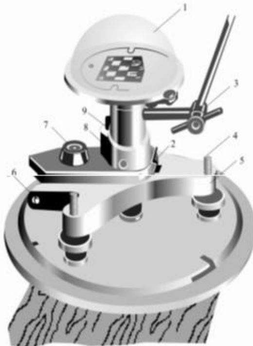
ნახ.11.1.4. უნივერსალური პირანომეტრი, თერმოელექტრული M-80M: 1 - პირანომეტრული თავსახური; 2 - საკეტი ზამზარა; 3 - დამაჩრდილებელის სამაგრი; 4 - ამწე ხრახნი; 5 - სტენდი; 6 - დასაკეცი ნაწილი; 7 - დონე; 8 - ხრახნი; 9 - საყრდენი
