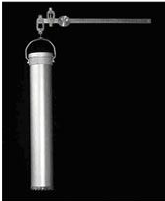
ნახ.11.3.7. წონითი თოვლსაზომი BC-4 , საერთო ხედი
