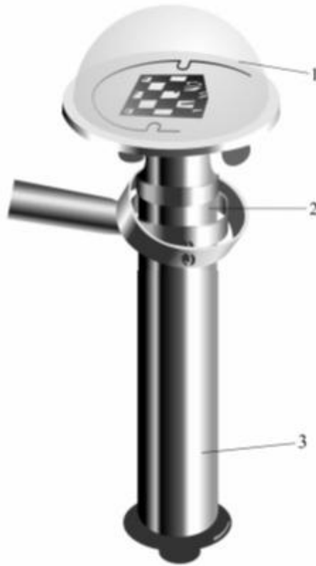
ნახ. 11.1.5. საველე ალბედომეტრი: 1 - პირანომეტრული თავსახური; 2 - საპირწონე; 3 - საწინააღმდეგო წონა
