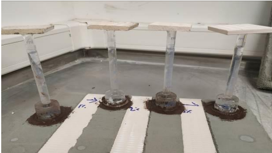
სურათი 11 ორი საათის შემდგომ 1% იანი კომპოზიტი აჩვენებს 0,6 მგ წყლის შეწოვას, 2%-იანი 0,5 მგ, 3% კი 0,2მგ პირველი არის შესადარებელი ეგზემპლარი, რომელიც შეიცავს 0%.
