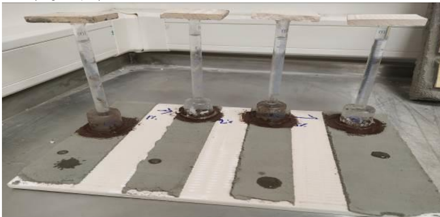
სურათი 9. ჰიდროიზოლაციის წყლის მიმართ გამძლეობის განსაზღვრა, პირველ ორ საათში
