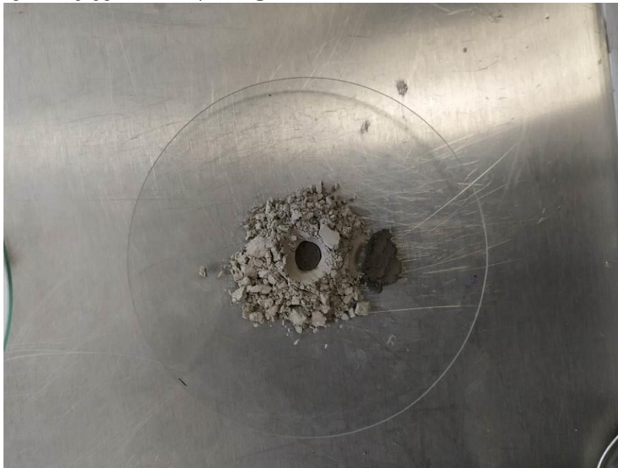
სურათი 6. ტეტრაეტოქსისილანი ვიზუალურად არ შედის რეაქციაში ცემენტთან
